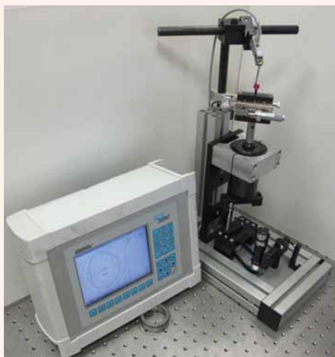
Obr. 6 Kluzně uložené vřeteno s chybou rotace 0,1 µm
