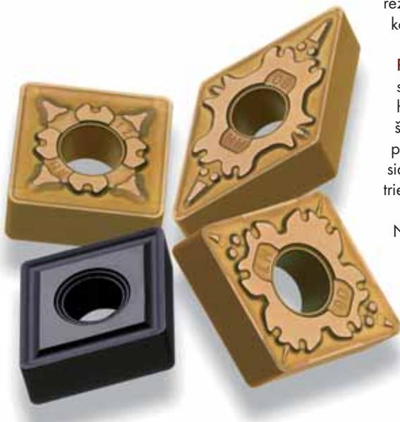
**MC7035** má PVD povlak, chrániaci proti tvorbe nárastkov a substrát, ktorý znáša extrémne vysoké teploty a jej zmeny a má vynikajúcu odolnosť voči lomu. Tieto vlastnosti ho predurčujú na nasadenie pri hrubovaní a prerušovaných rezoch. Je ideálny aj pre nízke rezné rýchlosťi – napríklad pri malých dielcoch.
