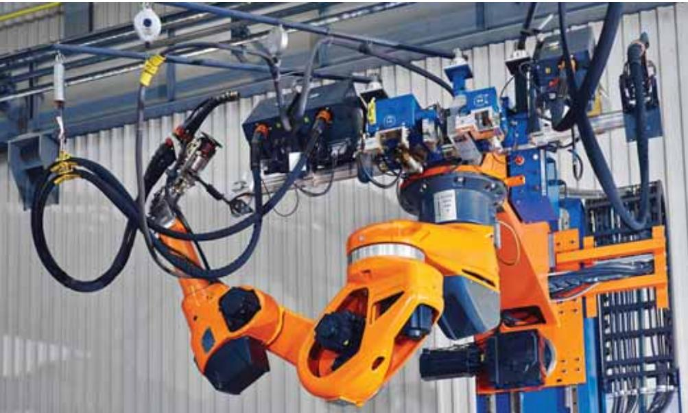
Robot QIROX přechází automaticky mezi svařovacím hořákem pracujícím v režimu jednoho drátu nebo tandemu – v závislosti na požadované svařovací rychlosti. Nad robotem se rovněž nachází automatická čistící stanice hořáku.
