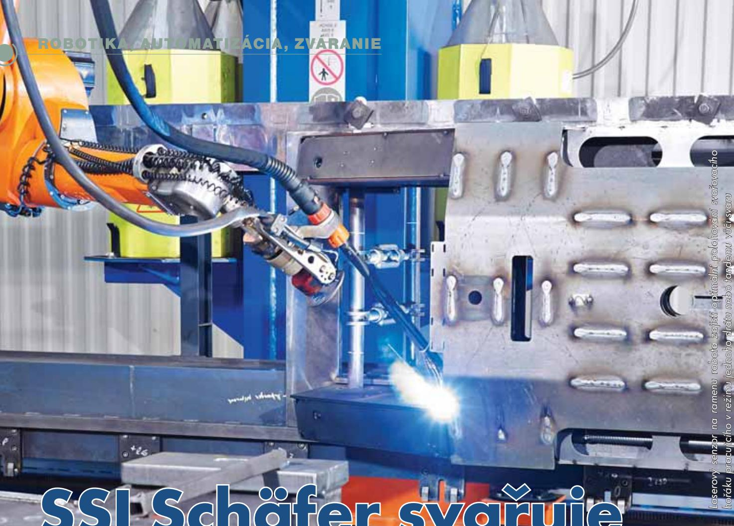
Laserový senzor na rámene robota zajistí optimální polohování svářovacího hořáku při práci "čho v režimu jednoho drátu nebo tandemu využíváho
