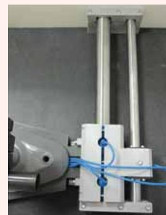
Obr. 5 Příklad větší verze přímovodné jednotky
