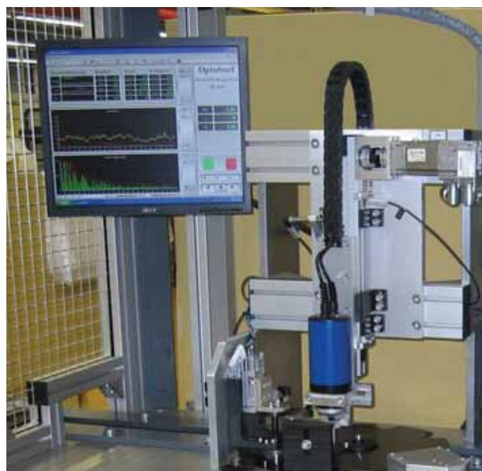
Obr. 1 Automat na kontrolu úchytek kruhovitosti, drsnosti a povrchových defektů
