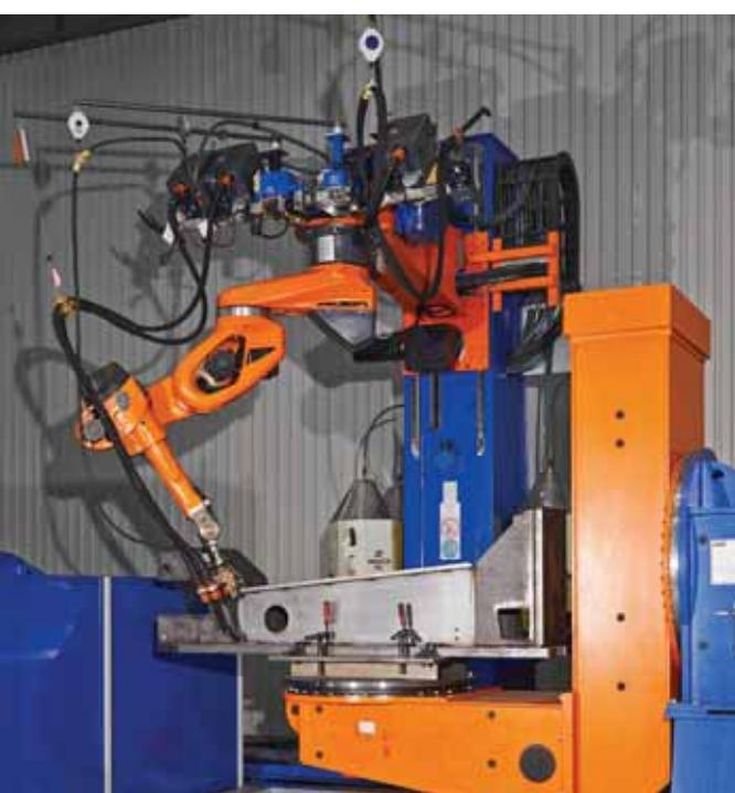
Na tomto otočném - výklopném polohovači o max. hmotnosti až 3 tuny se svařují komponenty - zde nosič pojazdového ústrojí, zatímco se mezi dva velké otočné stoly upíná nový obrobek
