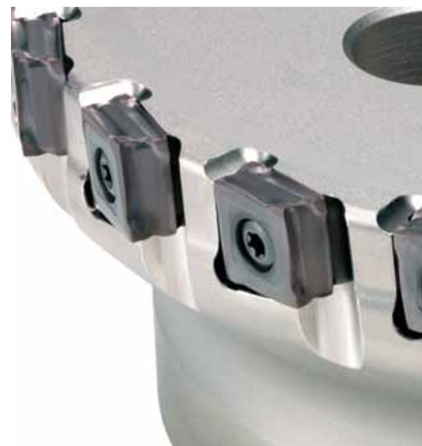
Dizajn frézovacích doštičiek, postavených vertikálne a upnutých na bočnej strane frézovacej hlavy, umožňuje prenos rezných sôl po celej dĺžke doštičky, nielen cez jej hrúbkou, čo enormne zvyšuje jej odolnosť v reze.
