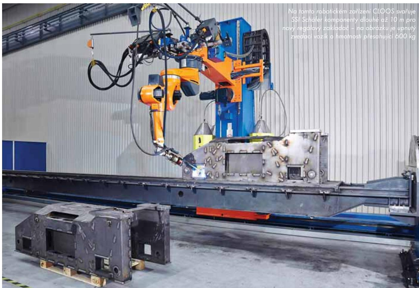
Na tomto robotickém zařízení CLOOS svařuje SSI Schäfer komponenty dlouhé až 10 m pro nový regálový zakladač – na obrázku je upnutý zvedací vozík o hmotnosti přesahující 600 kg
