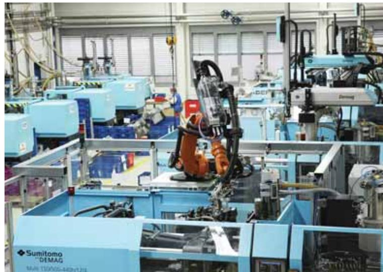
Systémový partner firmy KUKA, firma SAR, vyrábí pro robotická sklopna ramena kompletní periferní zařízení a drapáky, které jsou uloženy v tzv. drapákovém depu a tam čekají na své nasazení. Šestiosý robot tam uloží již nepotřebný drapák a za pomoci kódování si vyhledá z až šesti drapáků ten potřebný. „Naši zaměstnanci prokazovali od samého počátku velkou vlastní iniciativu na nových strojích a mezi nimi si osvojili know-how potřebné pro údržbu a montáž drapáků,“ vypravuje hrde Johannes Spatz.
