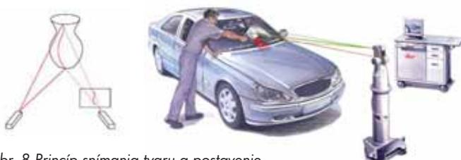
Obr. 8 Princíp snímania tvaru a postavenie zariadenia a objektu pri skenovaní [1, 4]
