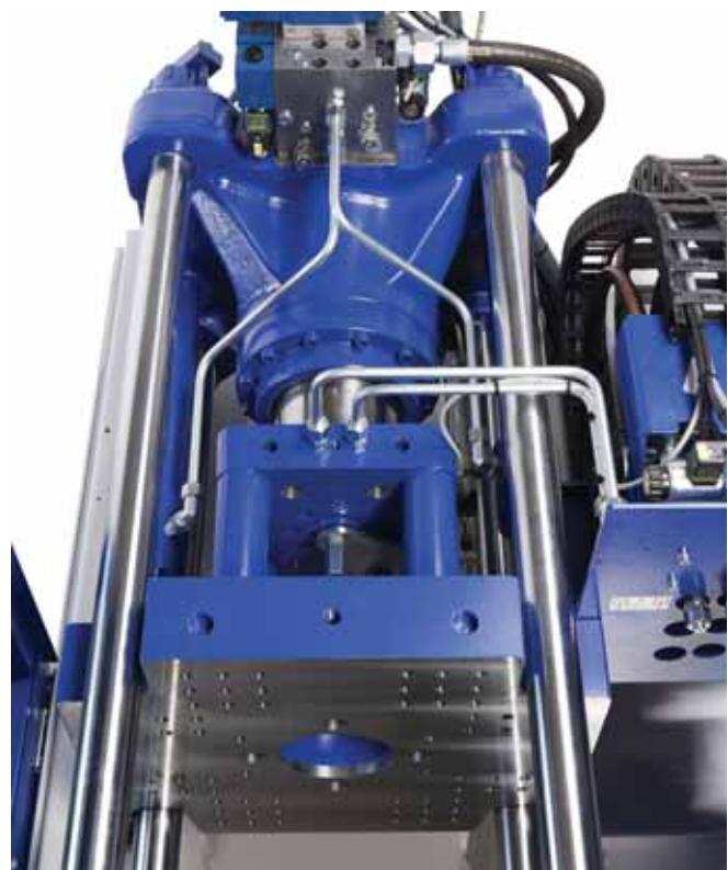
Další zvláštností stroje SmartPower je lehká otočná vstřikovací jednotka až do konstrukční velikosti 3400. Tímto otočným provedením vstřikovacího agregátu je výrazně usnadněn přístup k trysce a šneků a tím i jejich snadná údržba.
