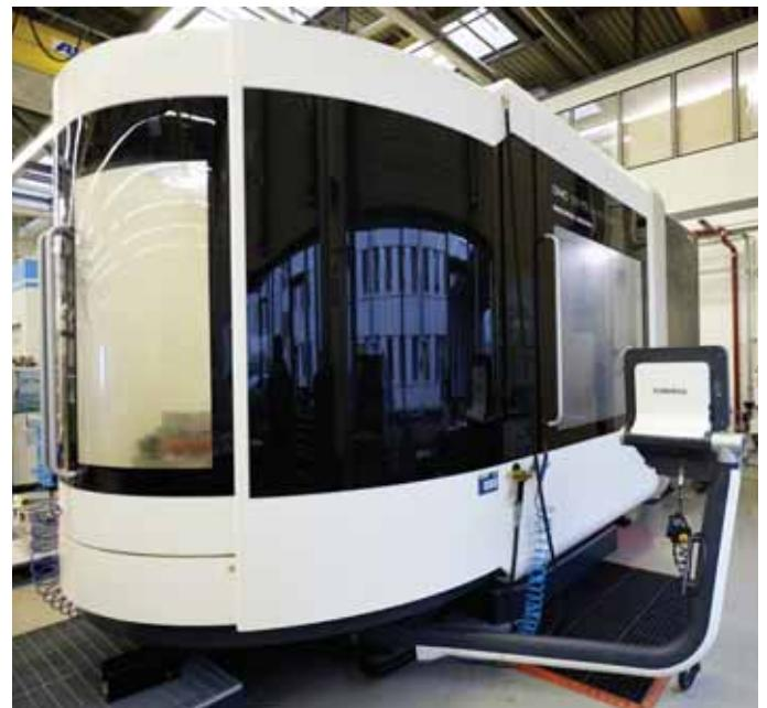
Společnost Airbus Defence and Space používá společně DMC 125 FD duoBLOCK® a virtuální stroj DMG MORI. Tento software simuluje kompletní geometrii a kinematiku stroje, stejně jako skutečné ovládání Simens.
