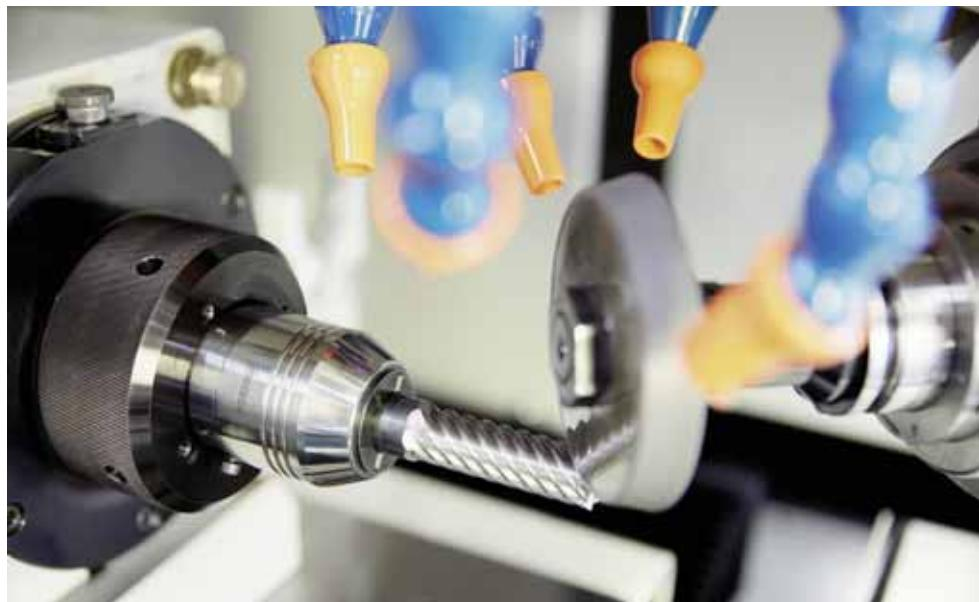
vo ovládané upínače pre automatické nakladanie stroja. Po ručnom vložení nástrojov do vysoko presných SCHUNK redukčných puzdier alebo špeciálnych predĺžení s uchopovacím krúžkom a následnom umiestnení do úložného stojanu, ich odtiaľ stroj automaticky vkladá do hydro-rozpínacieho upínača na vretene stroja. Dosahuje sa pritom vysoká opakovateľná presnosť a zvlášť výhodná je i nízka náchylnosť na hromadenie nečistôt. Navyše, rovnaký upínač nástrojov možno použiť pre rôzne upínacie priemery.
