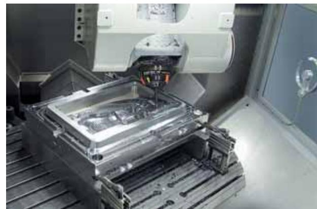
Prídavné vysokorýchlosné elektrovretné s otáčkami 60 000 ot/min umožňuje produktívne obrábanie malými nástrojmi
