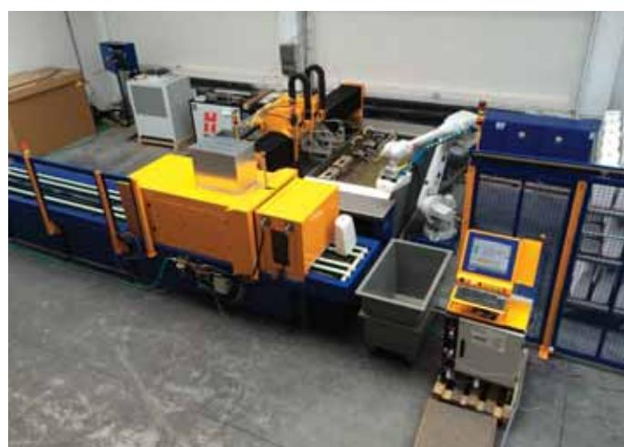
Obr. 3 Robotické pracovisko na rezanie sanitárnej techniky vodným lúcom pre zákazníka Villeroy & Boch Group, Rumunsko.
