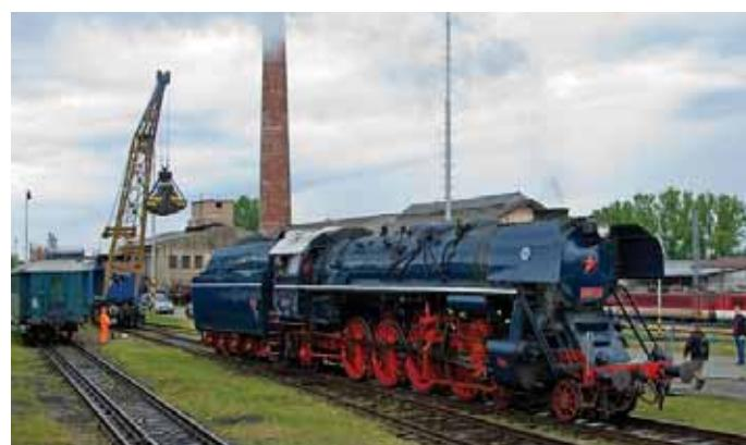
Obr. 5 Parná lokomotíva 498.104 vyrábaná v Škoda Plzeň (1954-55) tesne po vyzbrojení tendra uhlím, v pozadí žeriav s drapákom.
