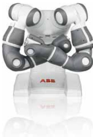
ABB vyvinula kompaktný dvojramenný robot schopný pracovať na úlohách montáže malých súčiastok s človekom bok po boku. Robot je pre človeka absolútne bezpečný a v priebehu milisekúnd preruší pohyb, ak dôjde ku kontaktu. Nová koncepcia bezpečnosti, flexibilné 7-osové ramená s opakovateľnosťou polohy 0,02 mm, v spojení s kamerovým lokalizovaním súčiastok a najmodernejším riadením robota, otvárajú v oblasti montáže súčiastok nekonečné možnosti. [www.abb.sk/robotics](http://www.abb.sk/robotics)
