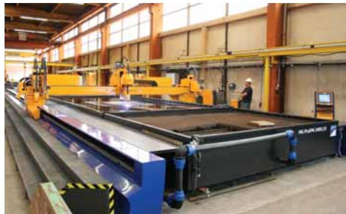
Obr. 1 Veľkoformátový stroj s prac. plochou 24 x 3,5 m s plazmovým rotátorom, mikroúderovým popisovačom a ABP skenerom na dodatočné úkosovanie - špeciálne riešenie s vodným stolom - zákazník ThyssenKrupp, Nemecko.
