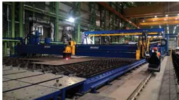
Obr. 2 Rezací stroj typu DRM s prac. šírkou 13 m ako súčasť panelovej linky v lodenici - špeciálne riešenie s pieskovacou hlavou.
