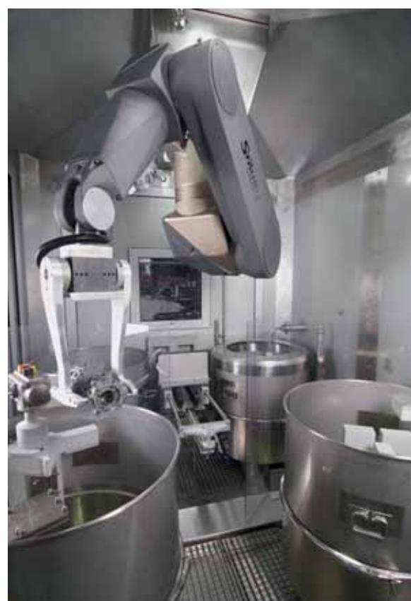
Stäubli RX160 HE instalovaný na strop se stará o kompletní manipulaci s díly ve výrobním závodě Dürr.
