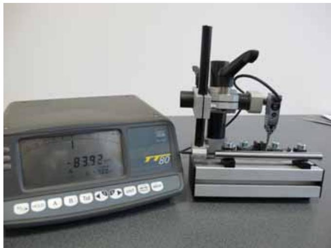
Univerzální - zakázkově koncipovaný stojánek maximálně využívající prvky z uhlíkového kompozitu s minimální délkovou teplotní roztažností
