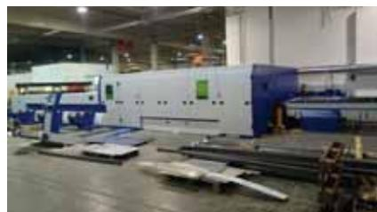
Obr. 6 MSF - špeciálna zostava kombinácie rezania rúr a plechov s automatickou nakládkou rúr
