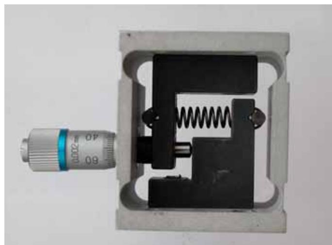
Hlavici pro jemné stavění úchylkoměru/snímače se submikrometrickou citlivostí. Vynikající stabilitu zajíšťuje monoblokový paralelogram s mikrometrickým šroubem o stoupání 0,1mm
