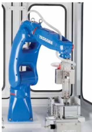
Štíhlý a dobře stavěný design dovoluje manipulátoru maximálně využít šířku pracovního prostoru a hladký povrch usnadňuje snadné čištění GP robotů. Pouze jeden jediný kabel je zapotřebí k propojení manipulátoru a kontrolní jednotky. Výhody tohoto řešení jsou menší opotřebování a zredukování výdajů na údržbu.
