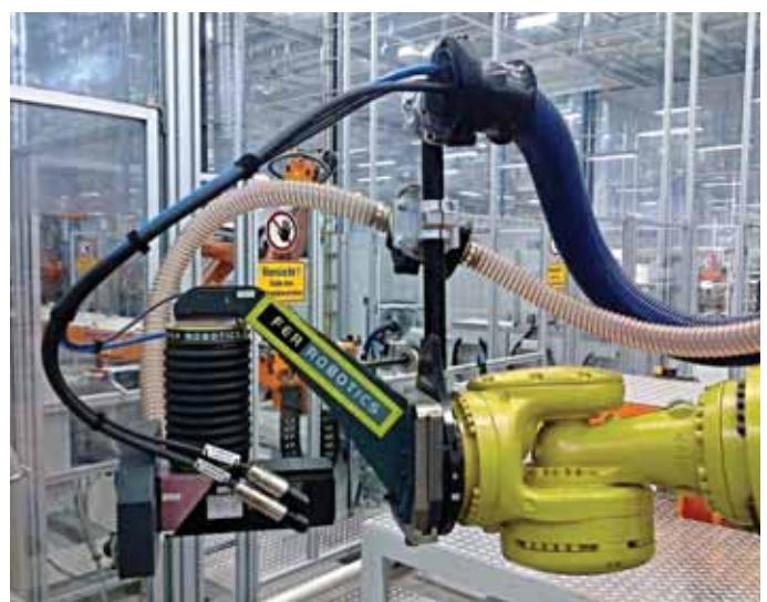
Robotická bunka pre brúsenie (s odsávaním) povrchov napr. zvarov.
