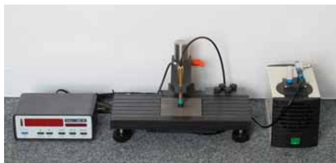
Univerzální stojánek na měření menších součástek s keramickým stolečkem a snímačem s vakuově odstavovaným doteckem
