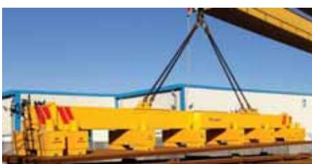
tování pouze při položeném břemenu. Systémy TECNOLIFT dosahují několikanásobně vyšší životnosti a až 95 % úspory energie oproti elektromagnetům.
