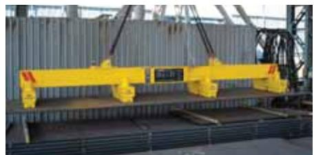
TM MULTI a BF MULTI zvládne manipulovat s plechy ve větší vrstvě od 1 mm a listovat dokáže od 5 mm plechů. Délka plechů může být od 3 do 15 m. Tyto systémy nepotřebují zálohové jistištění, a tím se stávají mnohem bezpečnější a úspornější oproti elektromagnetům. Díky této novince se elektro-permanentním magnetům otevírají nové možnosti v podobě využití v hutních skladech a výrobních provozech, kde je potřeba rychle manipulovat s větším objemem plechů najednou.
