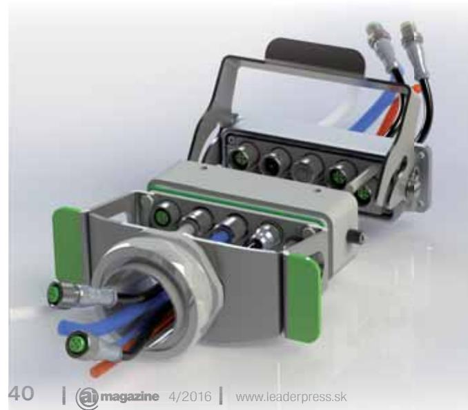
Spájanie konštrukčných dielov strojov je teraz úplne jednoduché vďaka praktickému konektoru Modlink Vario Square pre prevádzkové médiá od spoločnosti Murrelektronik v klasickom formáte pravouhlého konektora. Vedenia stlačeného vzduchu, kvapalín či energie môžete pripájať alebo odpájať jednou univerzálnou rukoväťou, dokonca aj pod tlakom, avšak spoľahlivo a bez únikov.
