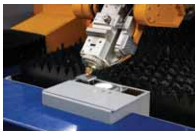
Obr. 4 Automatická kalibrácia snímača vzdialenosť v stanici LU3K pri úkosovom rezacom systéme
