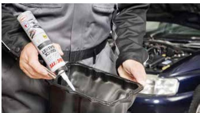
Loctite SI 5980 Quick Gasket je obzvlášť vhodný na utesnenie častí, ktoré sú v neustálom kontakte s olejmi
