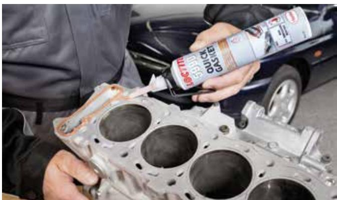
Loctite SI 5990 má vynikajúcu teplotnú odolnosť
