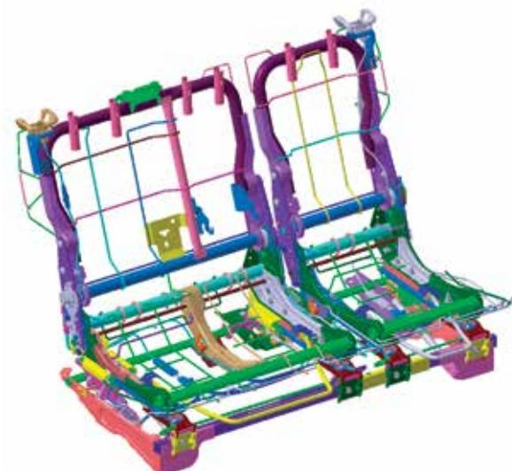
térsku výzvu sa považoval komplexný vývoj novej kovovej štruktúry druhého radu so špecifickým plne automatizovaným sklápacím mechanizmom, ktorý umožňuje sklopif operadlo a zároveň preklopif celé sedadlo k prednému radu. Tým sa dá úložný priestor maximalizovať bez toho, aby bolo nutné vyberať z auta sedačky.
