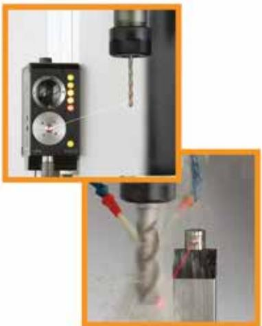
Velikost a stav nástroje hrají důležitou roli v mnoha procesech obrábění. Je velmi důležité zjistit velikost nástrojů před zahájením obrábění prvního dílce série. V průběhu obrábění je nutné kontrolovat, zda jsou používané nástroje neporušeny a v dobrém stavu.
