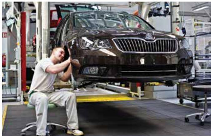
výrobní linky v kvasinském závodě. V souvislosti se zahájením výroby modernizovaného modelu Superb byly montáž a svařovna vybaveny novým zařízením. Kromě toho byly optimalizovány i logistické procesy: nápravy vozů se nyní dodávají na montážní linku v režimu just-in-sequence. Nově koncipována byla také zkušební zařízení na konečné montáži, například pracoviště kontroly geometrie. Zcela přepracovaný model ŠKODA Superb sjíždí z linky v modernizovaném závodě v Kvasinách.
