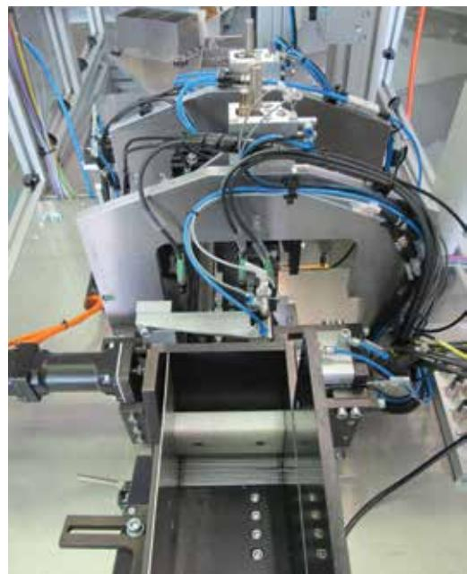
Obr. 5 Příklad automatu MESING na kontrolu velmi tenkých a dlouhých hřidelových součástek
