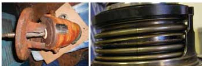
Zlomená lucerna a prasklý vlnovec od deformace tělesa z napětí od potrubí
