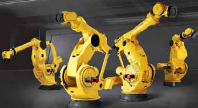
Správna voľba pre presné zdvíhanie ťažkých bremien, FANUC M-2000 iA/2300 je najsilnejší 6-osový robot na svete. Schopný zdvíhať a polohovať 2,3 tony do neuveriteľného stupňa presnosti. Robot prináša rýchlosť a flexibilitu do širokého rozsahu ťažkých zdvíhacích aplikácií nahradzujúcich žeriavy, zdvíháky a dopravníky.
