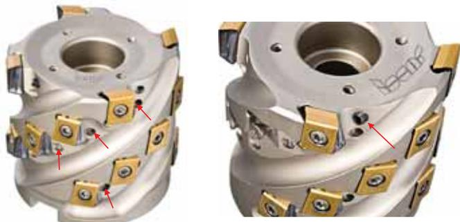
a) Rozšírená drážka frézy. Konštrukcia frézy umožňuje montáž trysiek v ústí otvorov pre prívod chladiacej kvapaliny.
