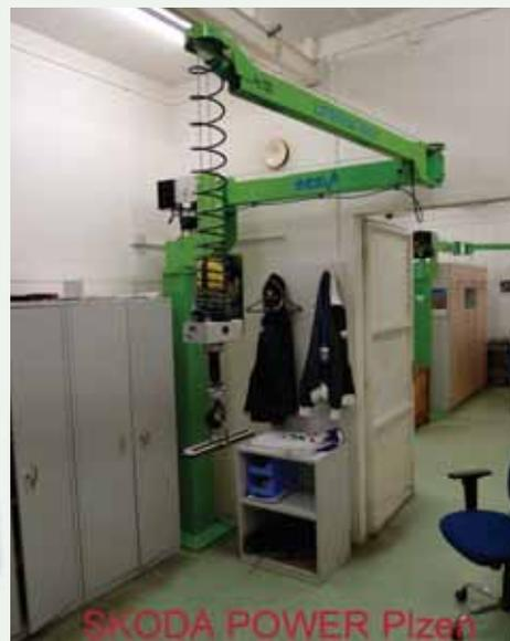
Operátor môže zdvihnúť bremeno s hmotnosťou až 320 kg jednoduchým dotknutím sa ser-vo-ovládacej rukoväte alebo záťaže samotnej a premiestniť ho ľahkým tlakom požadov- ným smerom, akoby bremeno vážilo len niekoľko gramov.
