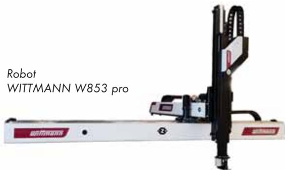
úspornější a obsahuje také méně kabeláže. Nově je řešen rovněž pohyb os. Robotu tak stačí k zakládání a odebírání dílů jen minimální otevření formy. Nosnost robota W853 pro činí 40 kg, v případě robota W863 pro je to 75 kg.
