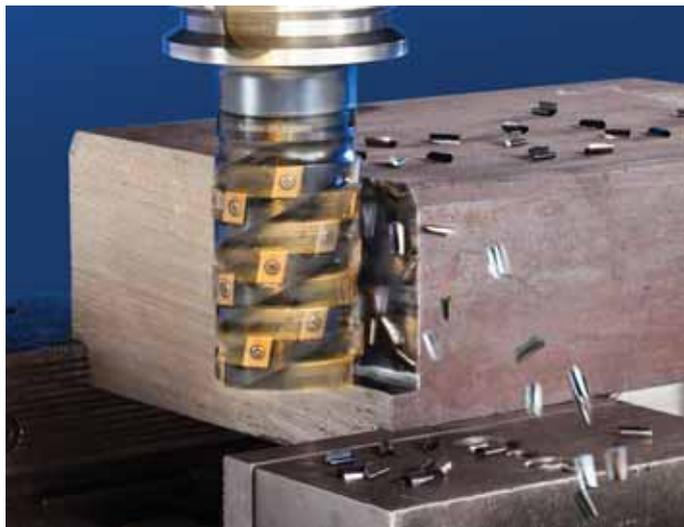
Obr. 1 Kvapalinové chladenie sa neodporúča pre hrubovacie frézovanie ocelí s použitím nástrojov T490 s predĺženou reznou časťou.
