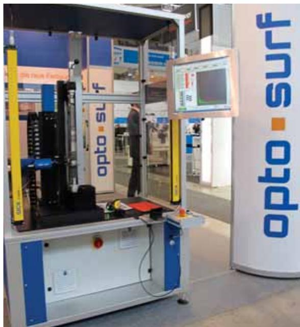
Poloautomatická stanice na kontrolu vlnitosti funkčních ploch převodkových hřídelí bezkontaktní disperzní metodou
