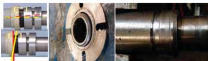
Poškozená mechanická ucpávka od nerovnoběžnosti čel a ložisko od deformace tělesa čerpadla z napětí od potrubí
