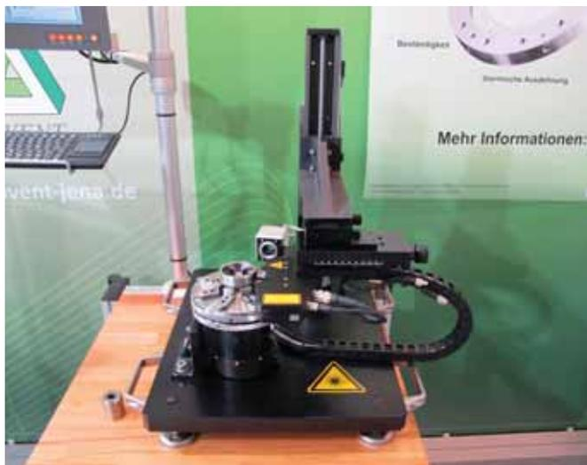
Laboratorní měřidlo drall-efektu se 2 disperzními měřicími metodami
