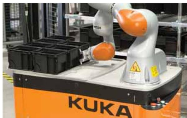
KMR iiwa automaticky dodává výrobní materiál pro montáž zápěstí robotu KR Quantec
