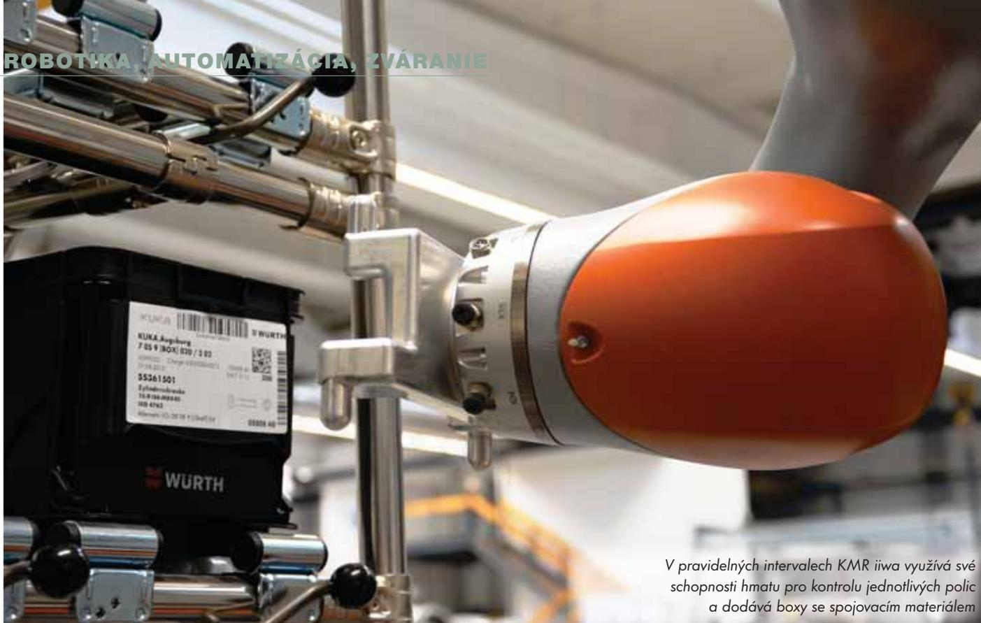
V pravidelných intervalech KMR iiwa využívá své schopnosti hmatu pro kontrolu jednotlivých políc a dodává boxy se spojovacím materiálem
