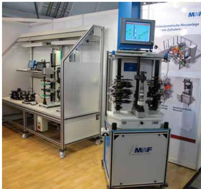
Dnes již standardní vícesnímačové měřidlo hřídelí
