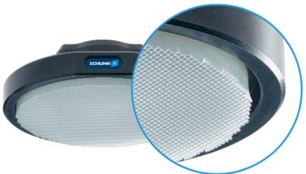
Spoločnosť SCHUNK svojou technológiou uchopovania ADHESO napodobnila jemnú chípkovú štruktúru gekónov. Chípky plastovej podložky vyrobenej zo špeciálnych polymérov sa pri uchopení pritlačia na povrch obrobku. Tým sa zväčšuje kontaktná plocha, ktorá umožňuje pôsobenie Van der Waalsových sil.
