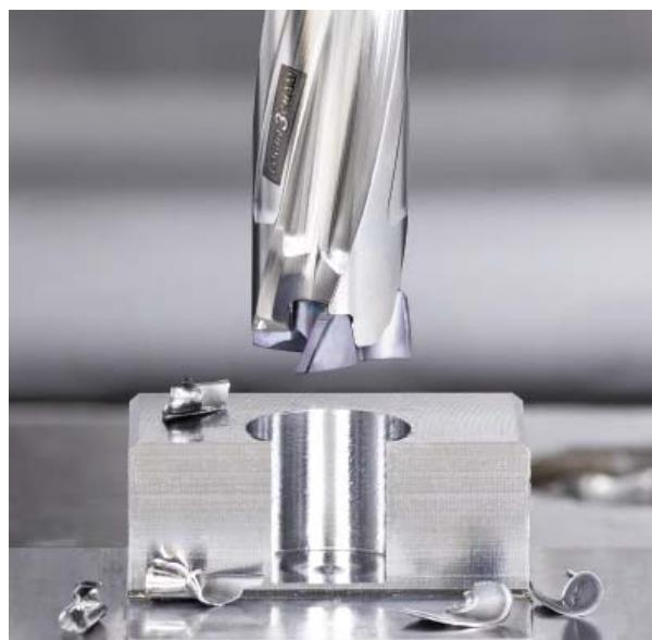
Obr. 1 3-beztový LOGIQ3CHAM vrták poskytuje takmer ploché dno otvorov.
