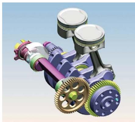
Obr. 4 Vyvažovací hriadeľ pripojený pomocou ozubeného prevodu [3]
