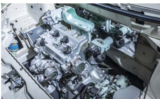
Obr. 2 Fiat Panda Aria – koncepcionálny automobil s prvým motorom TwinAir [2]
