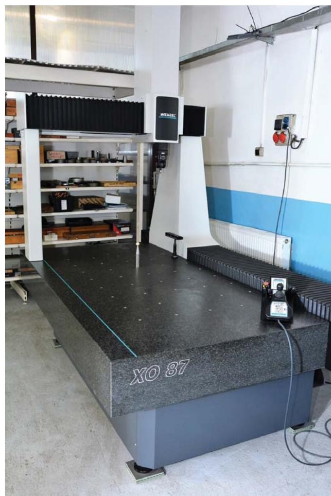
Výstupná kvalita je pre EMAT tools prvoradá. Počas uplynulého roka firma zakúpila 3D súradnicový merací stroj Wenzel s rozsahom 1 500 mm x 800 mm x 700 mm. Presné meranie vyžadujú nielen zákazníci, je tiež podmienkou získania certifikátu kvality.
