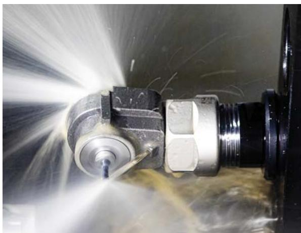
Obr. 4 Micro 90 – chladiacou kvapalinou poháňané vysokorýchlosné kompaktné vretená.
