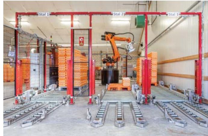
Společnost Meggson zavedla kompaktní paletizační systém na vejce s KR QUANTEC. Robot dokáže manipulovat s různými baleními vajec.
