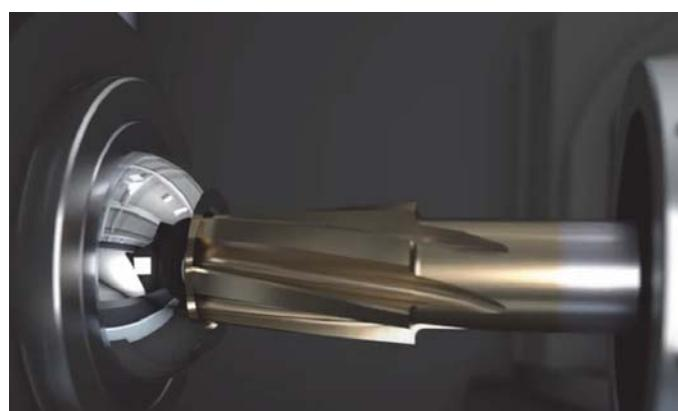
Dokončení kuželového otvoru provede speciální tvarový výstružník.
