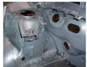
Obr. 1 Štruktúra spojov karosérie automobilu Golf V podľa [4] a pohľad na časť karosérie automobilu
