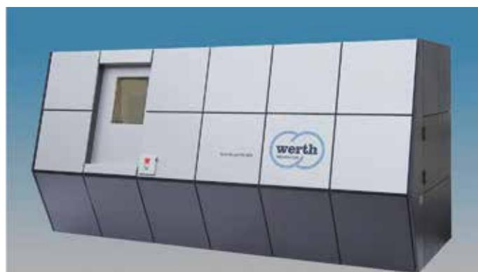
Multisenzorový souřadnicový stroj Werth TomoScope® HV 500 kombinuje CT s přesným kontaktním nebo optickým senzorem. Tato technologie umožňuje měření dílců rentgenovým snímačem. Dále poskytuje vysoce přesné měření funkčních rozměrů a měření kalibračních bodů pro kompenzaci tomografického měření. Pracovní stanice obsahuje kontrolní panel s vysoce výkonnou vyhodnocovací jednotkou pro složité matematické výpočty.
