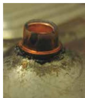
Obr. 19 Čap po deštrukcii v drieku a vytrhnutý čap so základným materiálem
