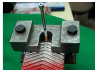
Obr. 16 Prípravok pre statickú skúšku čapov
