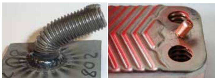
Obr. 14 Svorník M16 po vykonanej skúške ohybom podľa [11]
