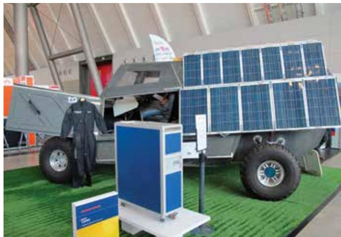
Obr. 4 Mobilita tak velkého solárního auta je možná jen celokompozitní karosérií
