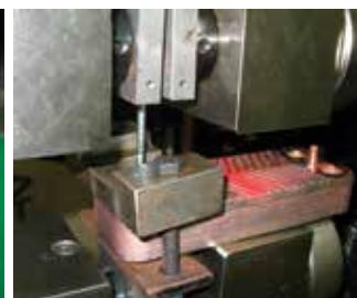
Obr. 17 Priebeh statickej skúšky ťahom priváraných čapov na trhacom zariadení TiraTEST 2300
