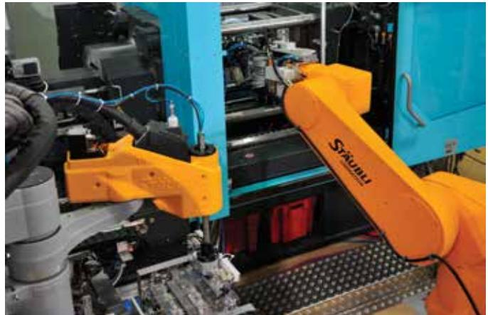
Zatímco SCARA robot připravuje kontakty do zásobníku, větší šestiosý robot obsluhuje vstřikovací lis
