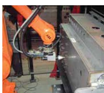
Obr. 12 Robotizovaný systém pre priváranie svorníkov [7]
