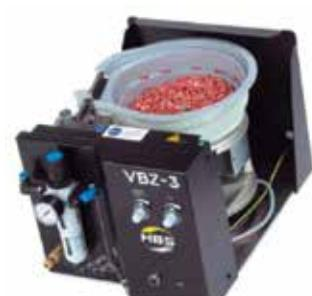
Obr. 13 Zariadenie firmy HBS pre automatický prívod svorníkov [10]
