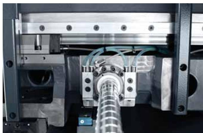
Inovativní teplotní management řady DMC V s chlazením matic kuličkových šroubů a vedení u všech tří lineárních os zabezpečuje nejvyšší přesnost obrobků.
