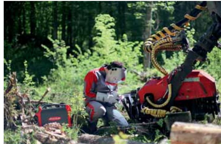
Obr. 3 Zvárací systém MMA AccuPocket 150/400 od spoločnosti Fronius umožňuje doteraz nedosiahnutú voľnosť pohybu pri ručnom zváraní a pri zváraní TIG
