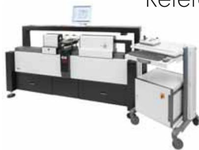
Tak jako u přístrojů řady ULM je i zde 100 % dodržen Abbého princip konstrukce přístroje. Měřící síla není nastavována pomocí závaží, ale elektronicky, což zaručuje její vysokou konstantnost. Přístroje pak disponují přímým měřením u PLM 600-2 v délce 200 mm s chybou měření  $\leq (0,085 + L/1 500)$  µm a u přístroje CiM 828 s délkou přímého měření 300 mm s chybou  $\leq (0,055 + L/1 500)$  µm. Automatický pohyb obou pinol je zajištěn na vzduchovém polštáři.
