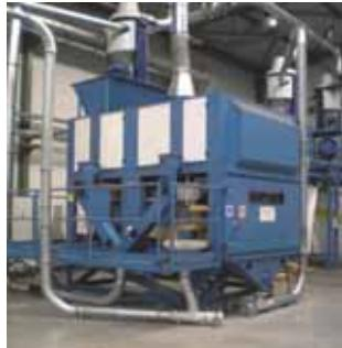
Obr. 9 Plnenie granulátu do vriec
