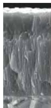
Hladký povrch povlaku zaistuje vynikajúcu odolnosť proti tvorbe nárastkov. Zosilnená vrstva TiCN zvyšuje odolnosť voči opotrebeniu pre mimoriadnu stabilitu.
