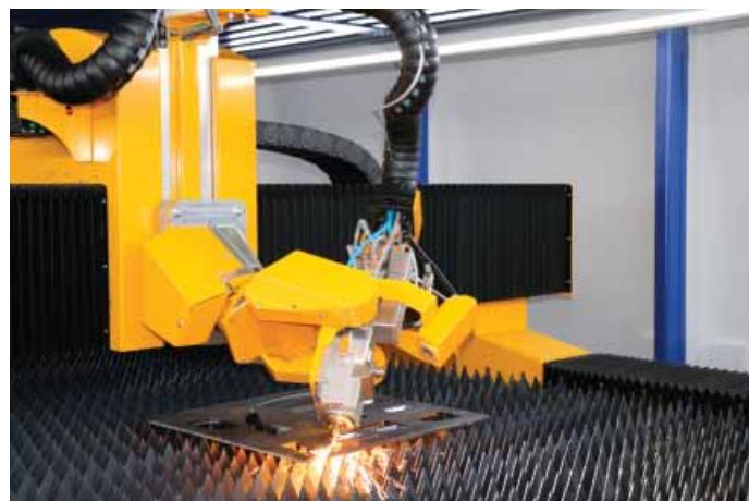
Obr. 1 Rezaci suport Lt na rezanie pod uhlom s laserovou rezacou hlavou HIGHYAG Bimo-FSC
