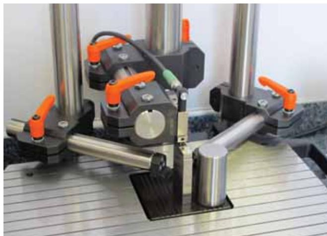
Detail měřicího místa stojánu s volně stavitelnými rameny i bočními opěrkami
