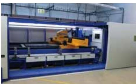
Obr. 5 MSF s doplnkovou technológiou na rezanie rúr do Ø 200 mm
