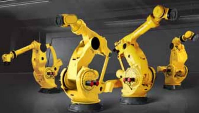
Správna voľba pre presné zdvíhanie ľahkých bremien, FANUC M-2000iA/2300 je najsilnejší 6-osový robot na svete. Schopný zdvíhať a polohovať 2,3 tony do neuveriteľného stupňa presnosti. Robot prináša rýchlosť a flexibilitu do širokého rozsahu ľahkých zdvíhacích aplikácií nahradzujúcich žeriavy, zdviháky a dopravníky.
