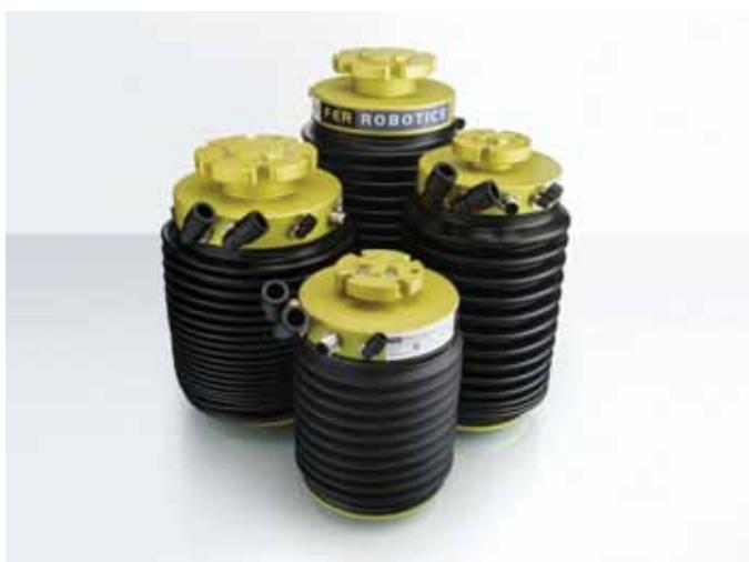
Veľmi často sa ACF príuba, v spojení s robotom, používa pre perfektnú prípravu povrchov (brúsenie, leštenie) pred penetráciou a striekaním, čo v konečnom dôsledku výrazne ovplyvní celkovú kvalitu produktu.
