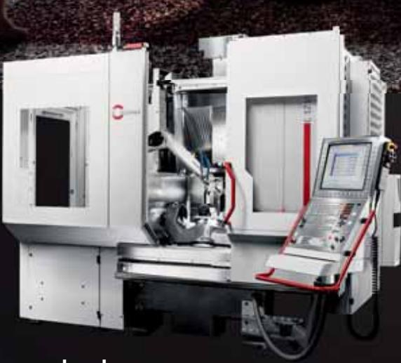
Obráběcí centra Hermle jsou velmi robustní a mikroskopicky přesná. V pěti osách se na nich obrábějí obrobky s hmotností až 2 500 kilogramů s přesností na několik mikrometrů. Dokonalé výsledky.
