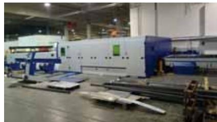
Obr. 6 MSF - špeciálna zostava kombinácie rezania rúr a plechov s automatickou nakládkou rúr
