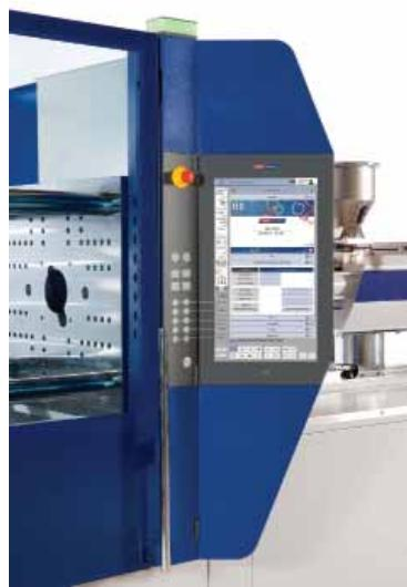
jsou ovládány volitelné provozní funkce a to prostřednictvím haptických tlačítek, umístěných na centrální konzoli stroje.
