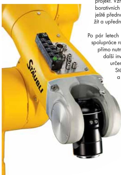
Sestiosý robot TX2-90 vybavený novým EtherCAT I/O modulem poblíž zápěstí pro snadné připojení periferií
