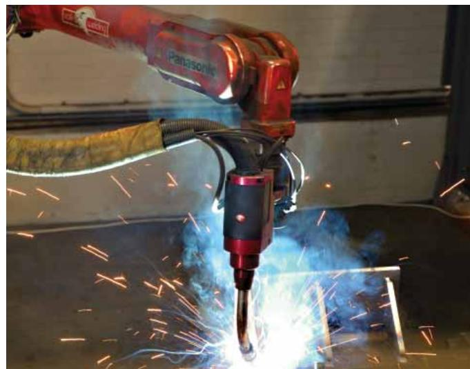
počas procesu zvárania. Inštalovaný robotický systém navyše dovoľuje aj zváranie viacerými materiálmi, je vybavený automatickou výmenou drôtu,“ dodáva R. Mareš.
