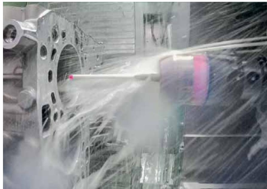
Efektivní měření drsnosti lopatkového kola pomocí nové sondy TC64-RG.
