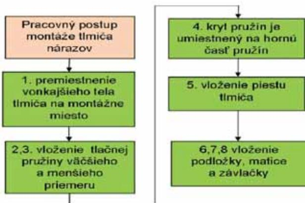
Obr. 4 Pracovný postup montáže tlmiča nárazov
