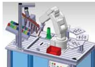
Obr. 7 Pracovný priestor robotizovaného montážneho pracoviska
