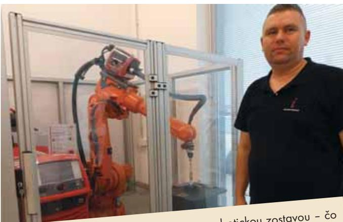
„Prišli sme sem s našim novým zdrojom – robotickou zostavou – čo je nový systém firmy Fronius. Novinka je v tom, že ten zdroj má dotykový displej riadený robotom,“ informuje nás Peter Belák, aplikačný technik firmy Fronius
