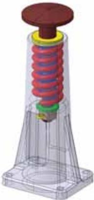
Obr. 3 Zmontovaná zostava tlmiča
