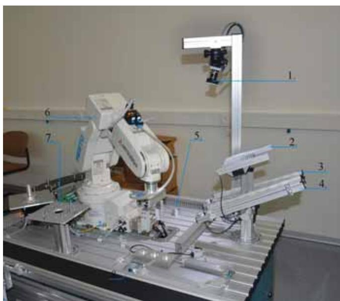
Obr. 1 Robotizované montážne pracovisko: 1. kamera, 2. zásobník pier, 3. zásobník vlhkomerov, 4. zásobník teplomerov, 5. robot RV-3SDB, 6. montážny modul, 7. držiak obrobku pre kamerovú kontrolu, 8. systémová paleta
