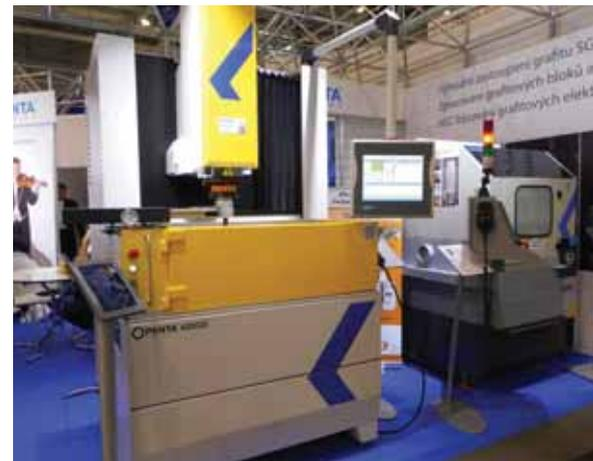
*Hľbička PENTA 433 je najmenší model EDM hľbičky, ktorý je vyrábaný v Prahe. Stroj je vybavený novým generátorom, nemeckou elektronikou a českým riadiacim systémom.*
