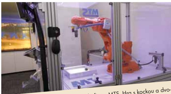
Robot na hranie, aplikáciu pripravila firma MTS. Hra s kockou a dvomi figúrkami, kde nejde len o zábavu, ale hlavne demonštráciu úchopu a kamerového systému.
