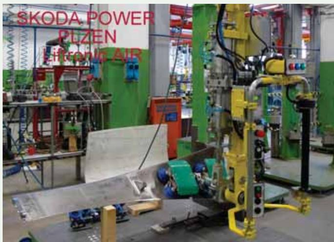
Balancéry sú elektronicky riadené systémy stáleho vyvažovania hmotnosti bremena do stavu „beztiaže“. Umožňujú jednoduchú manipuláciu s bremenom až do hmotnosti 310 kg, pri ktorej je námaha redukovaná na minimum a bremeno kopíruje pohyb ľudského ramena.
