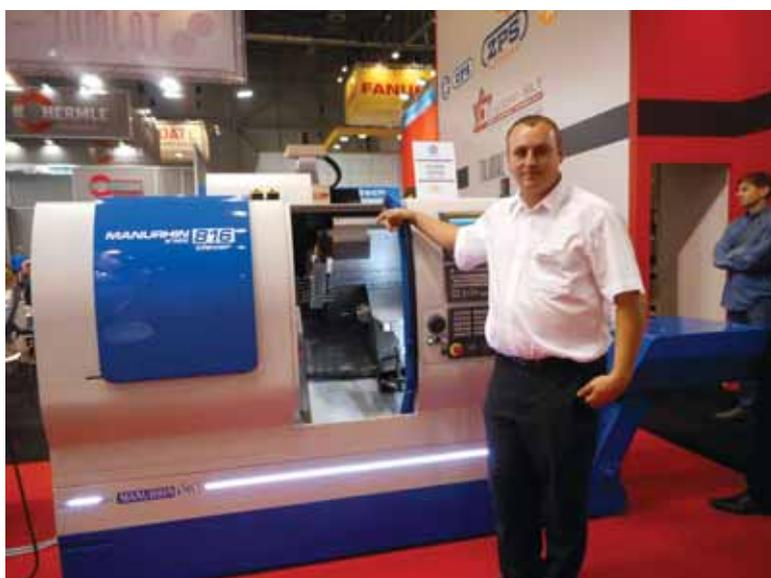
vrtání. Zdvih vřeteníku lze využít pro soustružení až 220 mm dlouhých dílců na jedno upnutí. Dílce nad 160 mm je možné volitelně vyvádět i skrz sekundární vřeteno. Délka obrobku je u tohoto typu strojů omezena v podstatě pouze délkou tyče. Stroj je dodáván s automatickým podavačem minimálně třímetrových tyčí s odměřováním a se zásobníkem tyčí. Snadná instalace nástrojů na nástrojových deskách umožňuje úspěšné použití tohoto stroje pro série počínaje řádově stovkami kusů," doplnil ředitel.
