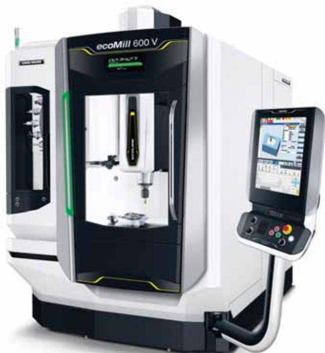
měny nástroje dosahuje až 1,3 sekundy. Řezná rychlost se celkově zvýšila až o 25 procent. Optimalizovaná konstrukce stroje zajišťuje mimoto vyšší tuhost při obrábění, přičemž 30 míst v zásobníku nástrojů ve standardu poskytuje vysokou míru flexibility výroby.
