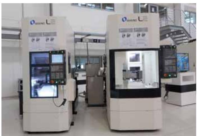
aj časom pre manuálne kontroly na stroji. Stroj a500Z prináša vysokú presnosť polohovania vďaka krátkej vzdialenosť medzi otočným bodom osi A a umiestením obrobku. Minimalizácia rozdielov hladín v indexovaných operáciách, schopnosť pohybovať ťažkými obrobkami a využitie vysokého zrýchlenia a spomalenia v simultánnom 5-osovom obrábaní ďalej znižuje obrábacie a vedľajšie časy.
