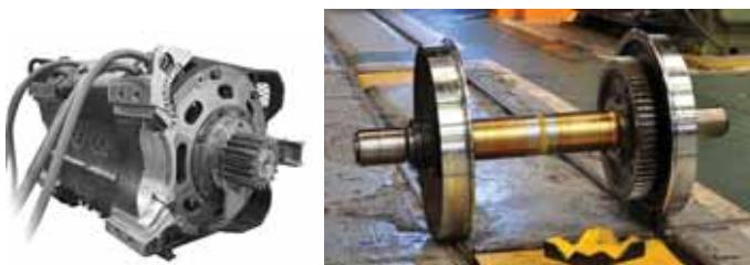
Obr. 4 Trakčný motor a hnacia náprava lokomotívy
