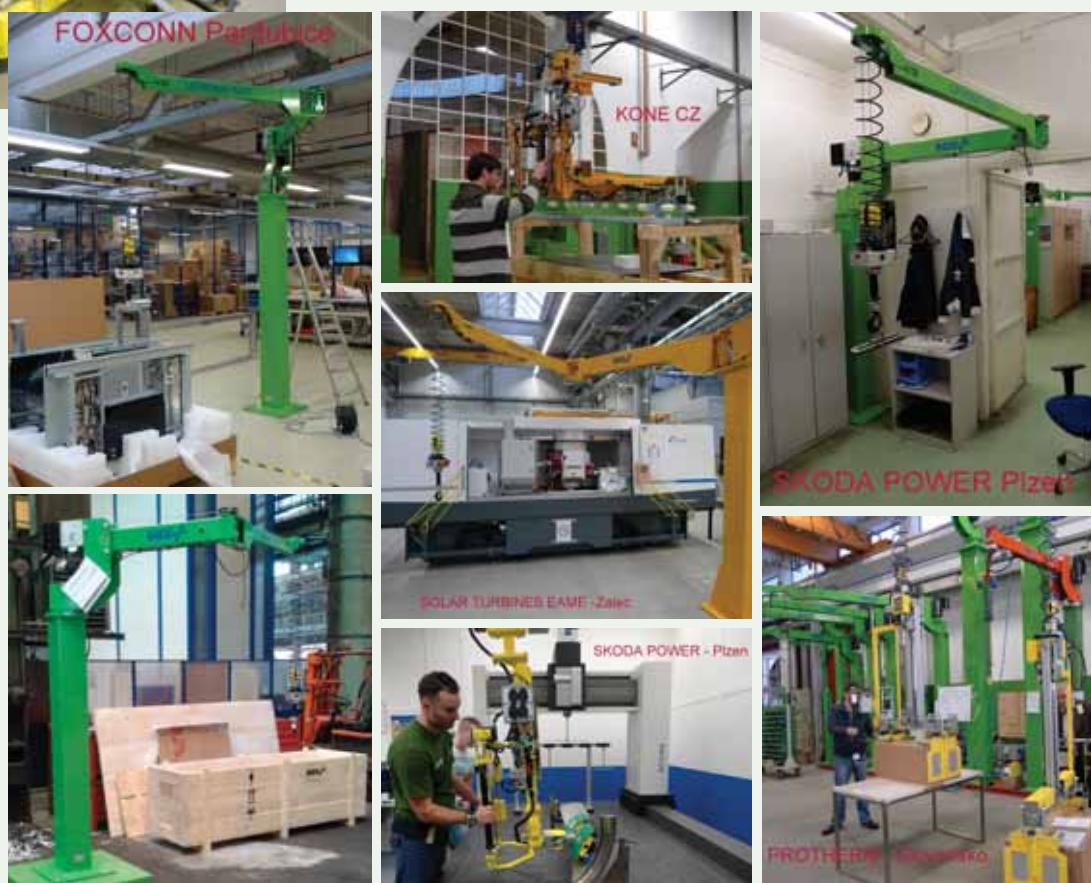
Operátor môže zdvihnuť bremeno s hmotnosťou až 320 kg jednoduchým dotknutím sa servo-ovládačej rukoväte alebo záťaže samotnej a premiestniť ho ľahkým tlakom požadovaným smerom, akoby bremeno vážilo len niekoľko gramov.
