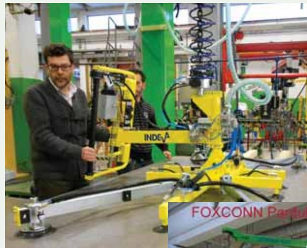
Balancéry sú elektronicky riadené systémy stáleho vyvažovania hmotnosti bremena do stavu „bezťaže“. Umožňujú jednoduchú manipuláciu s bremenom až do hmotnosti 320 kg, pri ktorej je námaha redukovaná na minimum a bremeno kopíruje pohyb ľudského ramena.
